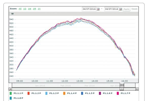
此圖顯示在安裝 3 個月後的系統中，最強與最弱模組之間出現 10W 的不匹配情況。利用功率優化器優化模組層級，可確保每一個模組都能產出最大的功率，而不會受到串列中的其他模組影響。
