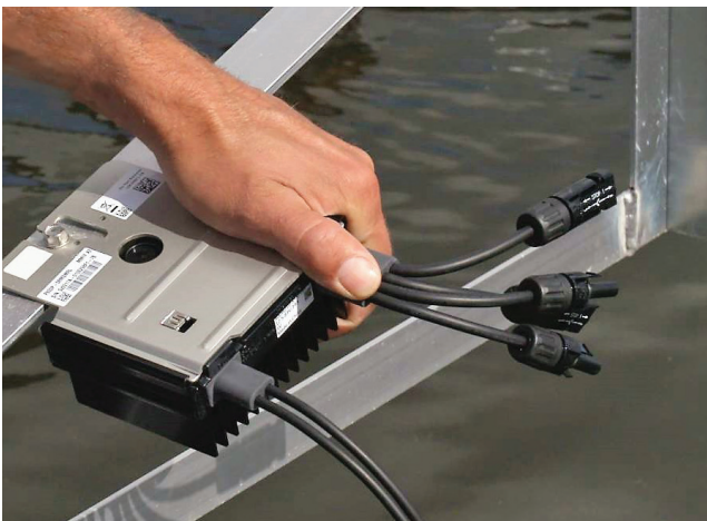
모듈 수준의 불일치를 줄여서 각 모듈에서 수집된 에너지를 최대화하는 1195 대의 파워 옵티마이저가 설치되어 있습니다.
