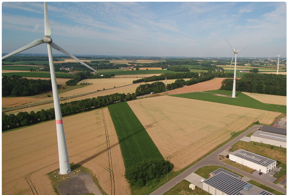
Enersol koos voor deze installatie voor SolarEdge om de lagere opbrengst, veroorzaakt door beschaduwing door de nabijgelegen windturbine, te minimaliseren.
