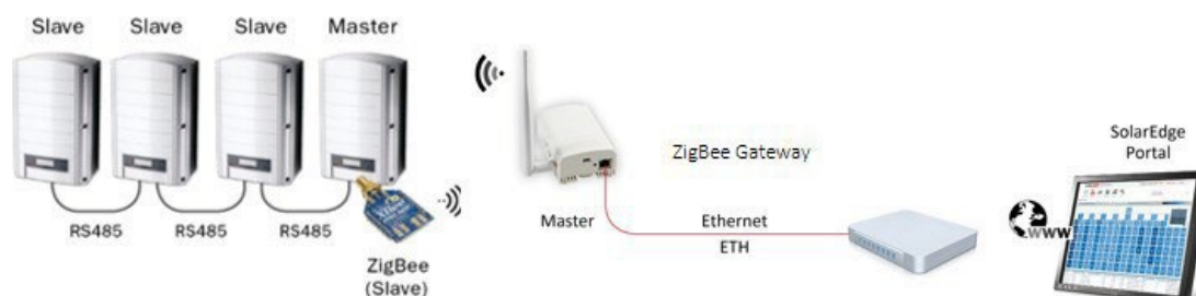
Figure 13 : Multi appareils, bus RS485, connexion ZigBee au serveur
