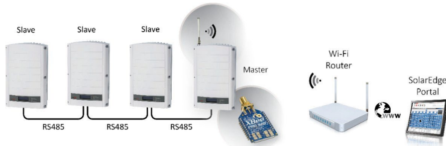
Figure 15 : Multi appareils, bus RS485, connexion serveur Wi-Fi
