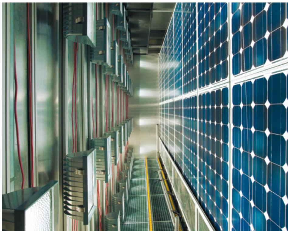
**Figura 1:** L'avanzatissimo laboratorio di test della Photon con simulatore solare ed elementi di ombreggiamento ©Guido Schiefer / photon-pictures.com
