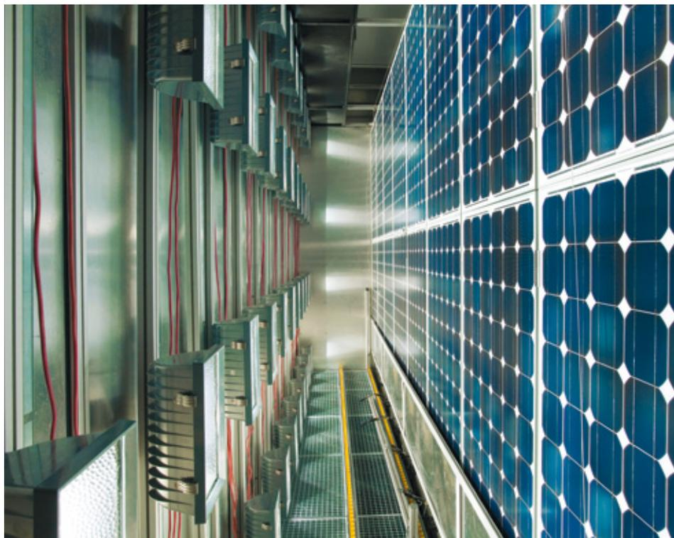
**Figure 1 :** Le site sophistiqué de tests de Photon, avec le simulateur solaire et des éléments d'ombrage
