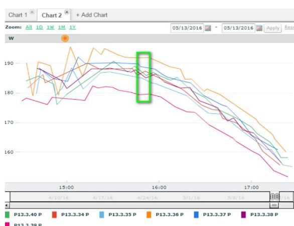
Figuur-10b: Vermogenscurven tonen 7% mismatch tussen de best en slechtst presterende zonnepanelen om 16.00 uur.
