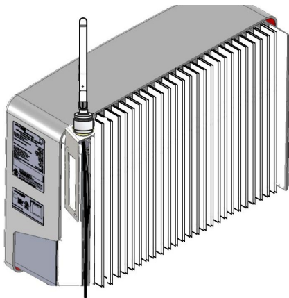
図3：アンテナケーブルの配線
