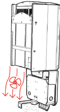
圖 10: 變流器風扇 - 空氣流通
