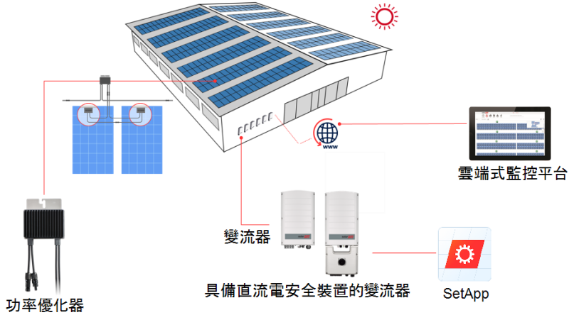
圖 1: SolarEdge 電力擷取系統元件
