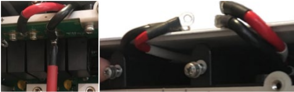
図6：6本のネジの取り外し
