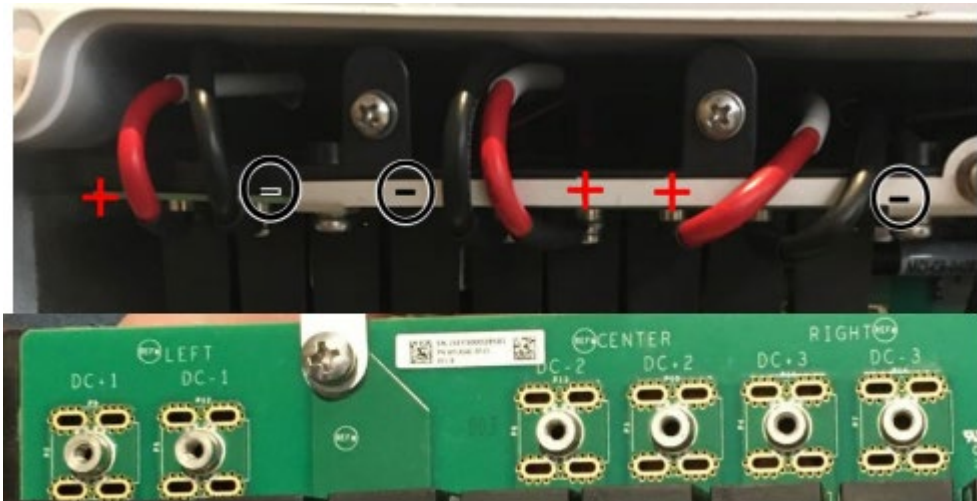
図18：正しい極性で配線する
