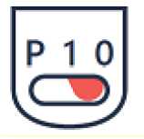
Figura 4: selettore ON/OFF/P su OFF
