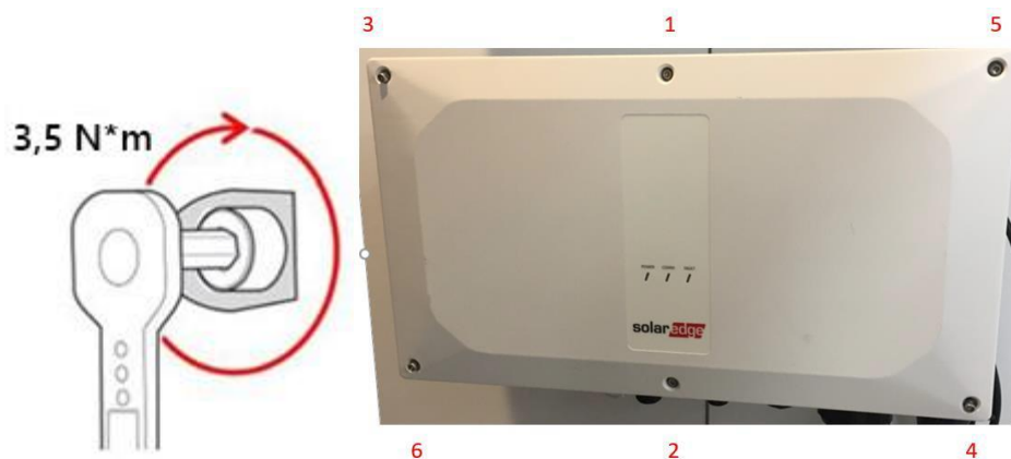
Figura 19: sequenza di serraggio delle viti
