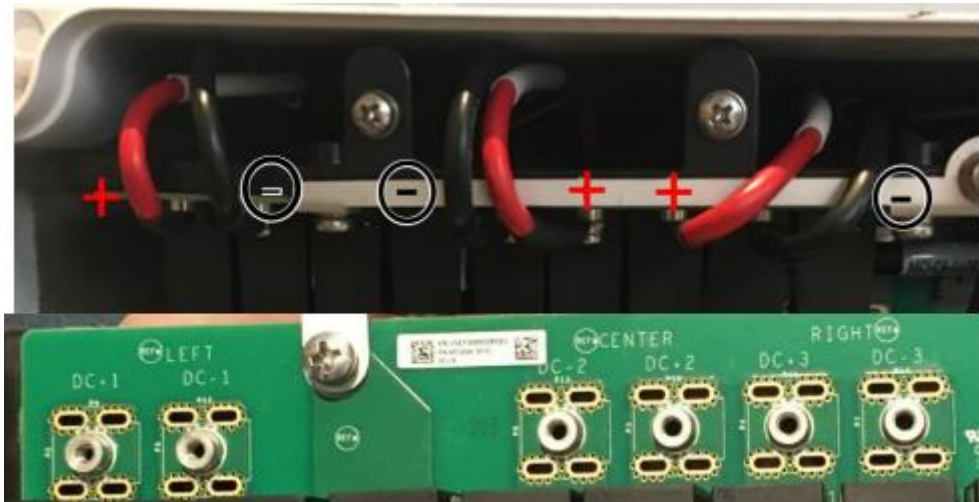
Figura 18: mantenere la corretta polarità
