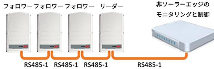
オプション2 - RS485-1を使用してフォロワーをリーダーに接続します。そして、RS485-2またはRS485-Eを使用して、リーダーを非ソーラーエッジのモニタリングデバイスに接続します。RS485バスのすべてのパワーコンディショナが異なったデバイスID (Modbus ID) に設定される必要があります。
