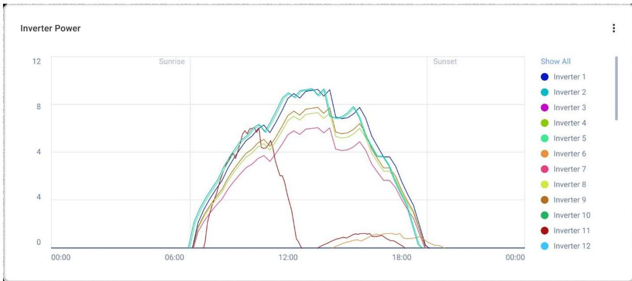
Questo grafico mostra la curva di potenza di ciascun inverter nell'impianto. È possibile confrontare tra loro tutti gli inverter nell'impianto per individuare anomalie o tendenze. Il grafico dispone di un'opzione per normalizzare i valori, calcolati in kWh/kWp per ciascun inverter, in un arco temporale selezionato.
