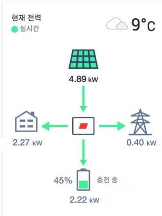
전력 흐름 위젯은 현장 구성요소 간의 실시간 또는 가장 최근의 전력 흐름을 보여줍니다. 실시간 데이터는 사이트가 사용 가능하고 일부 지역의 이더넷, WiFi 또는 LTE 에 연결되었을 때 표시되며, 3-5 초마다 자동으로 새로고침됩니다. 실시간 데이터를 사용할 수 없는 경우, 최종 업데이트 시간이 표시됩니다.
