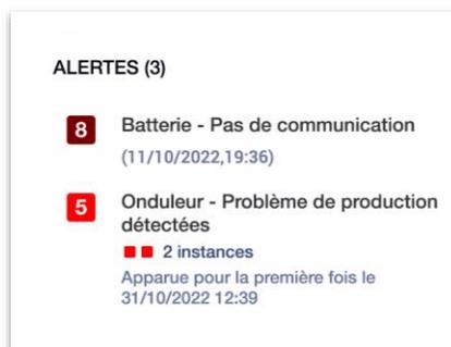
Le nombre total d'alertes en cours est indiqué en haut du widget. S'il y a plusieurs alertes du même type, elles sont regroupées sous forme de liste. Dans l'exemple ci-dessus, le site a 2 alertes de production de l'onduleur et une alerte d'absence de communication de la batterie.
