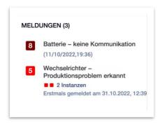
Die Gesamtanzahl der aktiven Warnmeldungen wird oben im Widget angezeigt. Wenn mehrere aktive Warnmeldungen desselben Typs vorliegen, werden diese unter einem Eintrag zusammengefasst. Im Beispiel oben liegen für diese Anlage 2 Wechselrichter-Warnmeldungen bezüglich der Produktion sowie 1 Batterie-Warnmeldung bezüglich Kommunikationsverlust vor.
