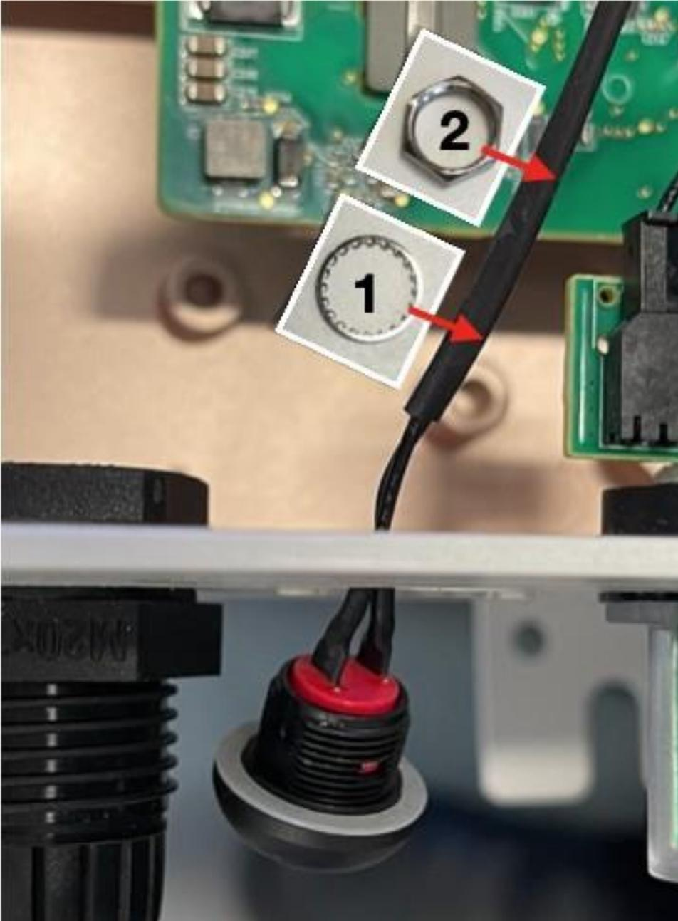
3. 自立運転ボタンのケーブルコネクタを通信基盤の受け口に接続してください。
