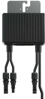
Figuur 9a. Power Optimizer met twee korte ingangskabels aan de paneelzijde, een korte en een lange uitgangskabel aan de stringzijde
