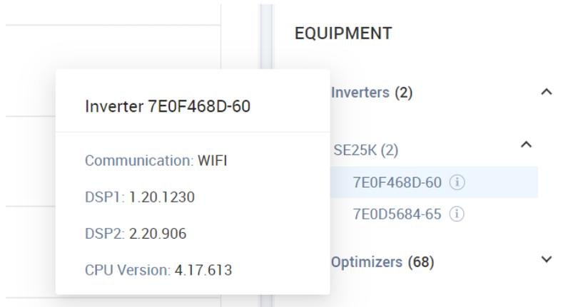
Wenn die CPU-Version älter als 4.17.xxx ist, aktualisieren Sie den Wechselrichter auf die neueste Version.
