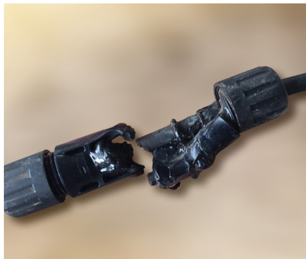
Figur 6: MC4-kontakt efter ljusbågsfel
