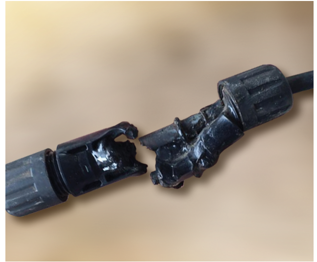
Figuur 6. MC4 na vlamboogfout
