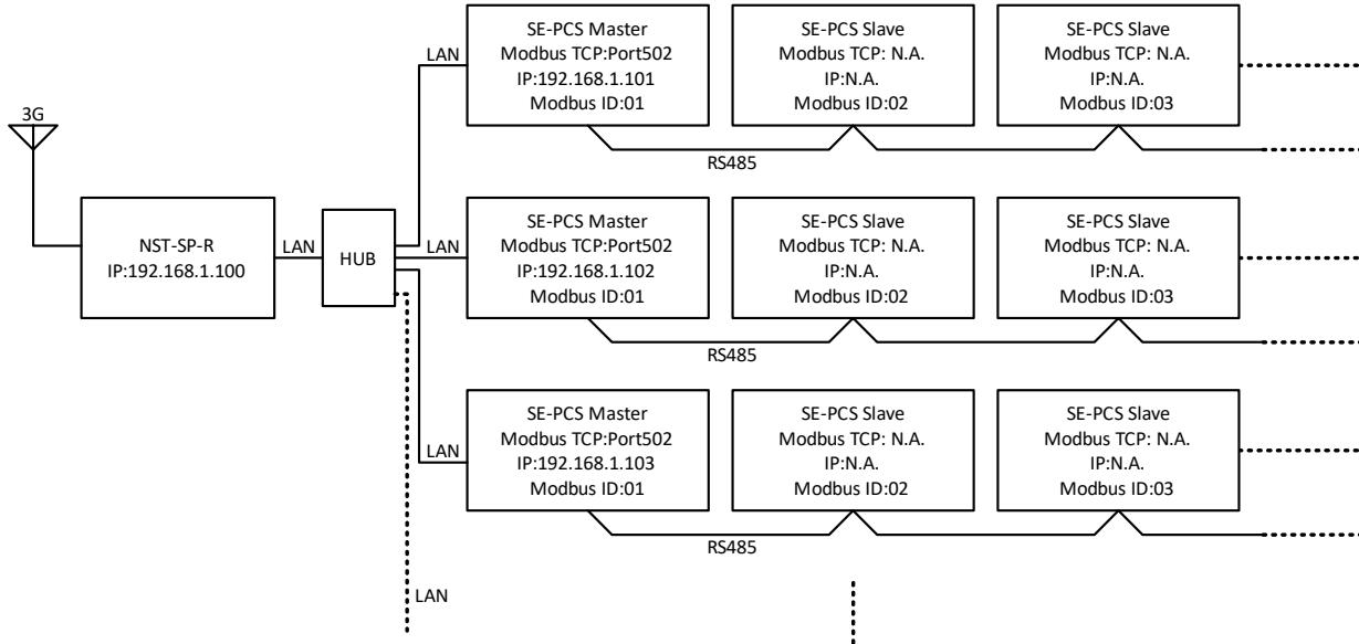
**(注意 1)**各パワーコンディショナへの Modbus ID の振り分けは、エナジーソリューションズ様に提出された"PCS マスター・スレーブ構成表"の通りに左側から順に 1、2、3、...と割り振る様お願いします。
