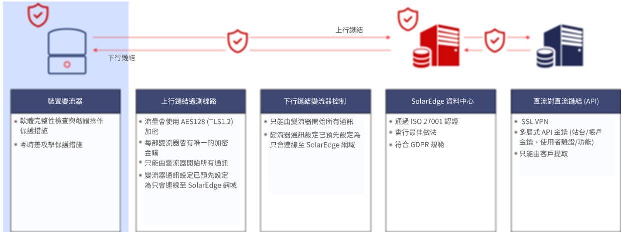
SolarEdge 變流器具備多層安全性 (包括內建與第三方機制)，其設計目的在限縮隨機與鎖定目標的網路攻擊面。
