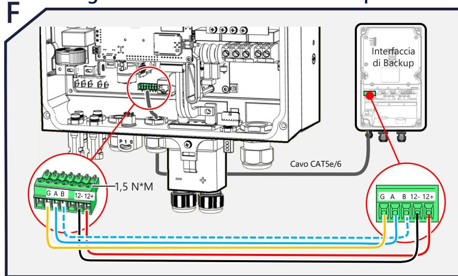
**Collegamento del contatore** (Nel caso in cui venga utilizzata la BUI, il contatore deve essere collegato tramite l'interfaccia di backup. Il contatore inline può essere collegato anche in modalità wireless)
