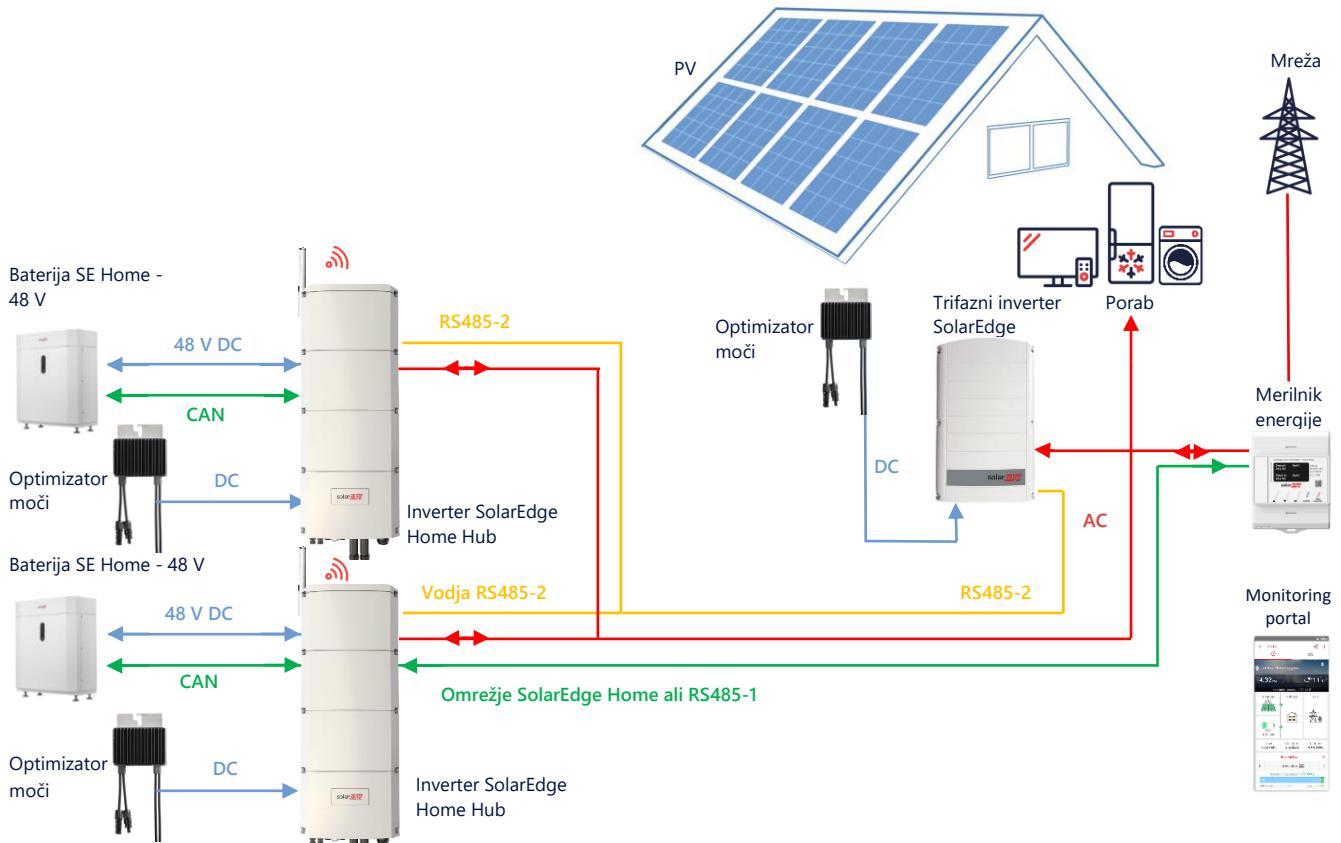
To trije inverterji Home Hub lahko imajo tudi optimizatorje moči ali pa so lahko povezani na AC vir napajanja, ki ni SolarEdge. V primeru da se trije inverterji Home Hub uporabljajo z drugim trifaznim inverterjem SolarEdge, drug inverter NI MOGOČE povezati na vodilnega kot sledilca. Z drugimi besedami, na konfiguracijo vodilni-sledilni ni mogoče priključiti več kot 3 inverte.
