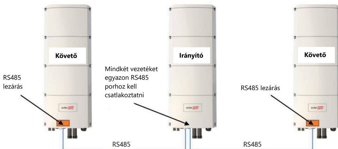
2. ábra– Vezetékes kommunikáció az inverterek között
