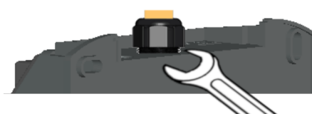
Bild 6-15: Dra åt kabelförskruvningen från baksidan
