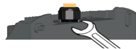
Fig. 6-15: Serrare il passacavo a vite dal retro
