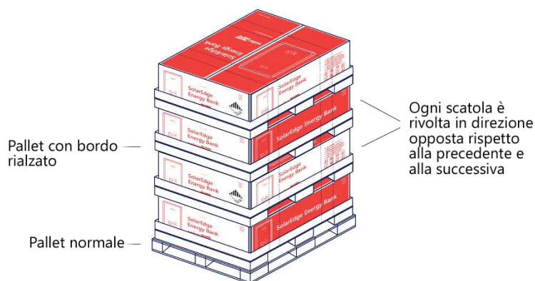
Figura 1: Pallet imballato per la spedizione con un massimo di quattro scatole di batterie 400V SolarEdge Home
