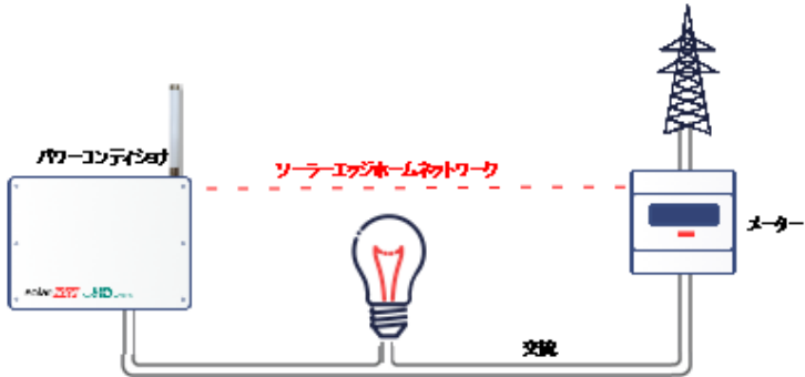
図 5:ソーラーエッジホームネットワーク上で1台のパワーコンディショナとメーター接続 (1)
