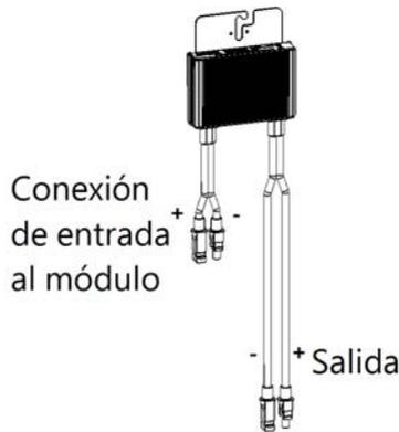
Figura 4: Conectores del optimizador de potencia
