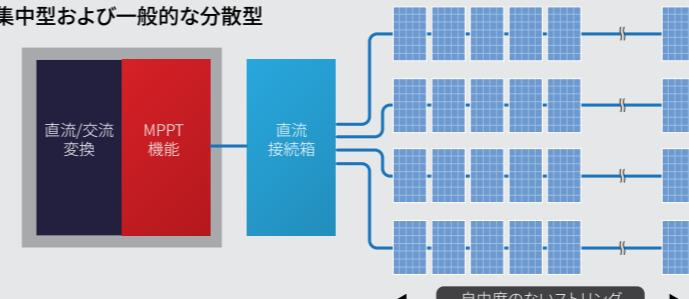
集中型では、アレイレベルのMPPTによりミスマッチの影響は広範囲にわたり、アレイ全体で出力損失を生じかねません。また、直列数はストリング間で同一でなければならず、ストリング構成に大幅な制限があります。さらに、直流接続箱が必要な場合も多くBoS(周辺部材)コストがかかります。
