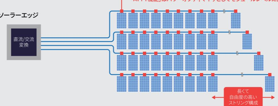
モジュールレベルのMPPTによりミスマッチによる出力損失を大幅に軽減することができます。また、ソーラーエッジの固定ストリング電圧技術により、一般的なパワーコンディショナより長く、自由度の高いストリング構成が可能となりました。
