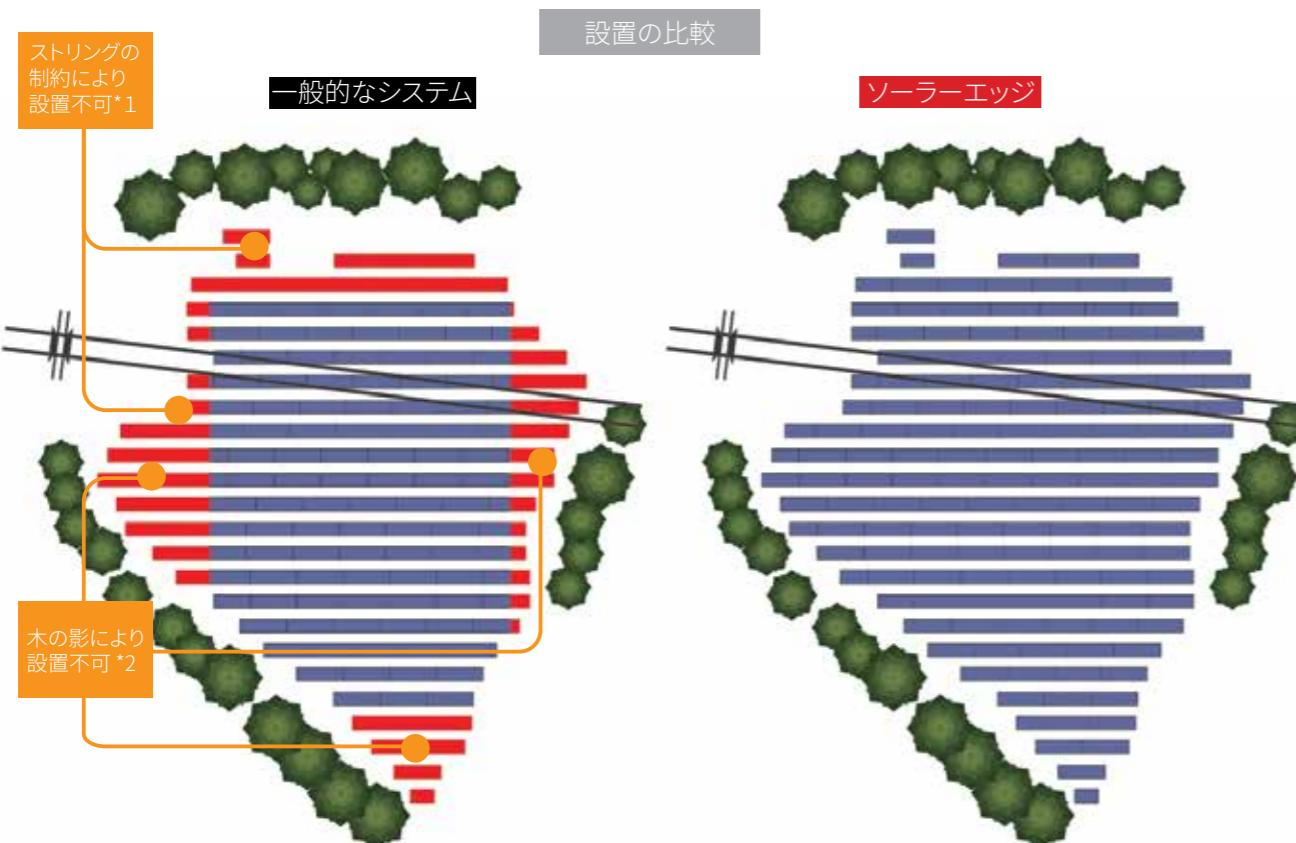
\*1:ストリングが短く長さの統一も必要なため、物理的に設置できない場所が生じます。
