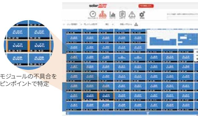
モジュールレベルのピンポイントな自動アラートにより、迅速な障害検知、正確なメンテナンスおよび早期対応を可能とし、ダウンタイムの削減につながります。このアラートには、障害が発生した場所、障害の説明および障害状況が含まれます。また、電力の閾値を設定することで、パフォーマンスが低下したモジュールに対してアラートを出させたり、日の出や日没などの1日の時間帯にあわせて設定をカスタマイズすることもできます。
