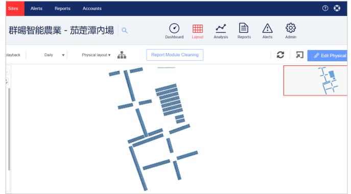
SolarEdge 監控系統能追蹤模組等級的系統性能和進行遠端的故障診斷及排除
