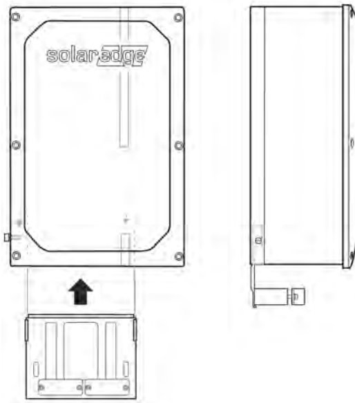
Figura 3: Instalación de la interfaz de respaldo
