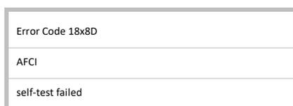
O inversor repete continuamente o autoteste de detecção de arco até que seja bem sucedido. Se o problema persistir, entre em contato com o Suporte SolarEdge.
