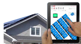
Monitoramento a nível de módulo
