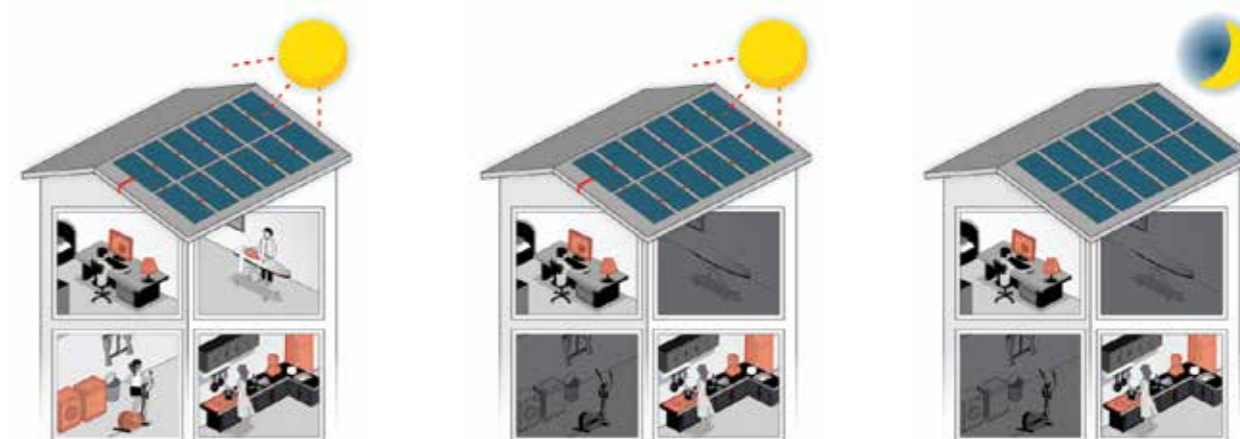
Ładowanie baterii z instalacji fotowoltaicznej
