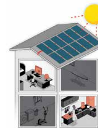
Overdag: Belangrijkste apparaten worden eerst door het PV-systeem en vervolgens door de thuisaccu van stroom voorzien. De thuisaccu kan, wanneer nodig, door het PV-systeem worden opgeladen.
