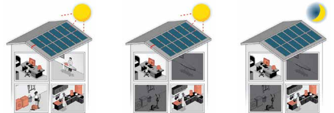
Charger la batterie depuis le système photovoltaïque
