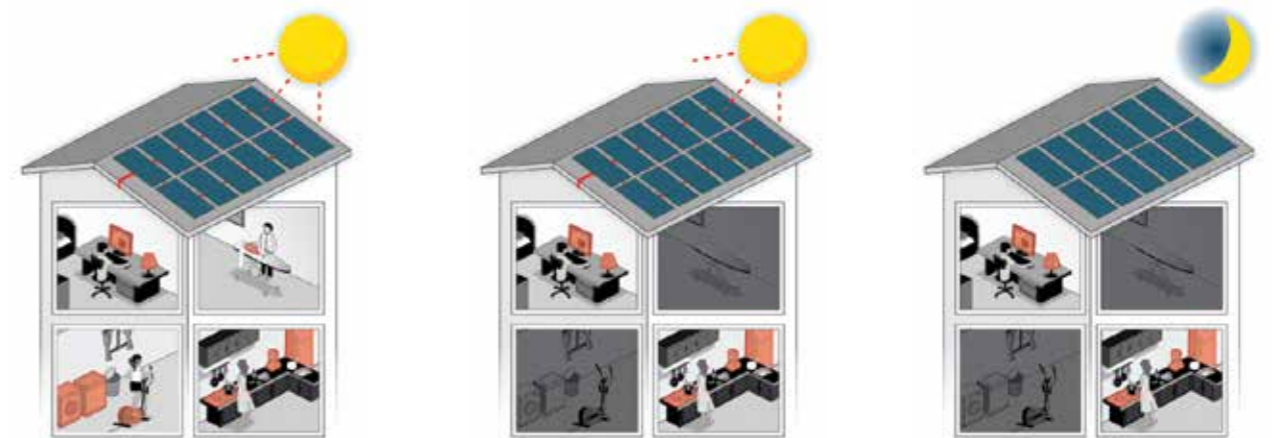
Charger la batterie depuis le système photovoltaïque
