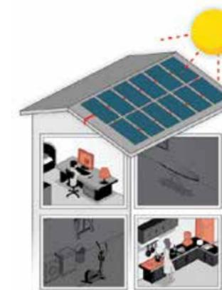
Tagsüber: Wichtige Verbraucher werden vorrangig über das PV-System, nachrangig über die Batterie mit Strom versorgt. Bei Bedarf kann die Batterie über die Solarstromanlage geladen werden.
