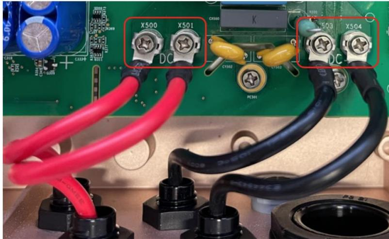
図6：4本の直流電線の取り外し
