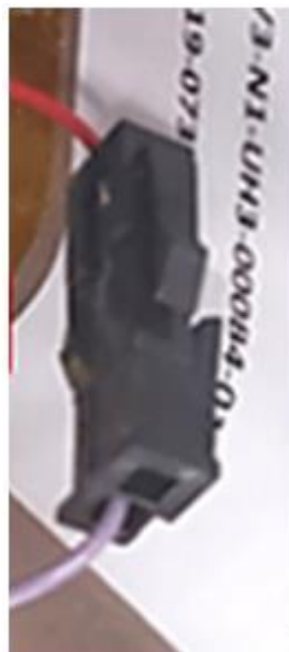
図8：信号ケーブルをパワーコンディショナのソケットに接続
