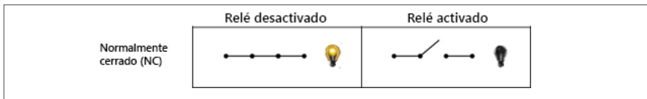
Figura 2: modos del relé NC
