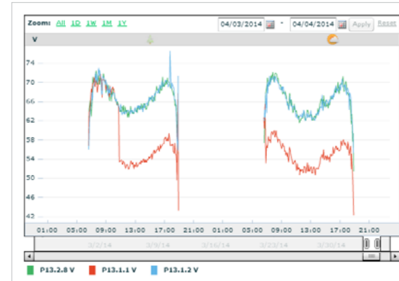
Es fácil identificar un fallo en el diodo de derivación gracias a los gráficos de tensión a nivel de módulo. El módulo averiado funciona solo a 2/3 de la tensión (5/6 en este caso de optimizador de potencia conectado a dos módulos).
