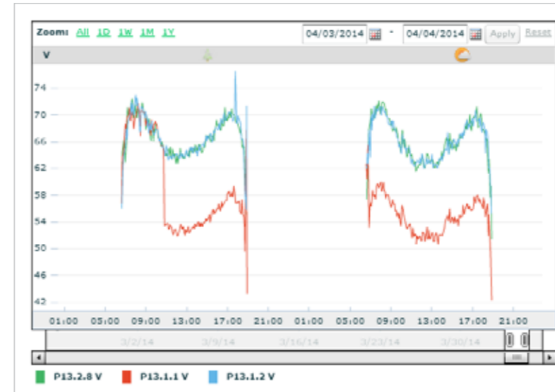
Łatwo jest zidentyfikować awarię diody bocznikującej z wykorzystaniem wykresów napięcia modułów. Uszkodzony moduł generuje tylko 2/3 napięcia (5/6 w tym przypadku optymalizatora podłączonego do dwóch modułów).
