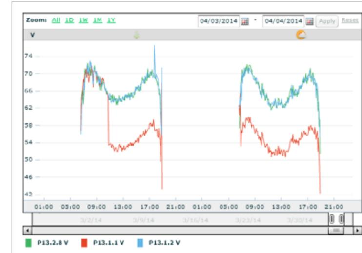
利用模組層級電壓圖表輕鬆確認旁路二極體故障，故障之模組僅會輸出 2/3 的電壓（兩個模組皆連接功率優化器時，可輸出 5/6 的電壓）。
