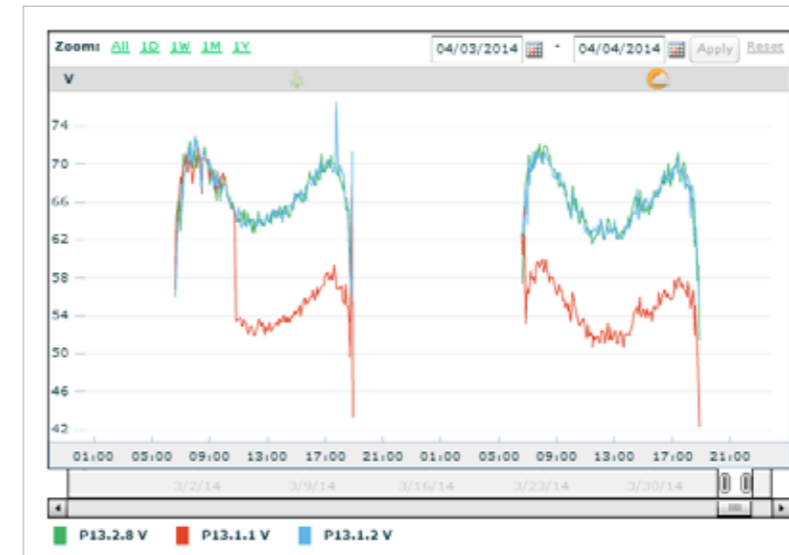
Het is eenvoudig om de defecte bypass diode met de spanningsgrafieken op paneelniveau te identificeren. Het defecte paneel levert slecht 2/3 van de spanning (in dit geval 5/6, omdat twee panelen met één optimizer verbonden zijn).
