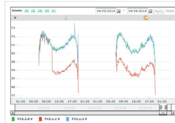
Il est facile d'identifier une défaillance des diodes de bypass à l'aide du graphique de la tension. Le module défaillant aura une puissance de 2/3 de la puissance maximale (5/6 dans le cas d'un optimiseur connecté à 2 modules)
