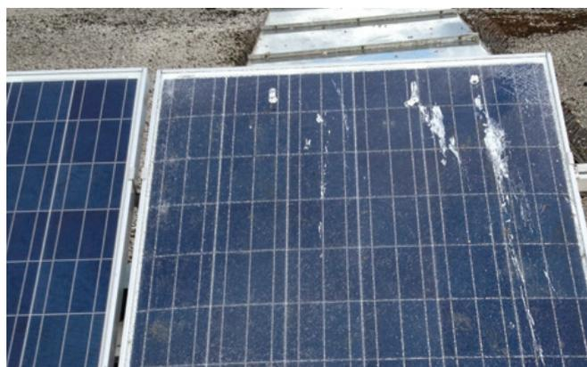
最初の設置の際に壊れた一枚のモジュールは、ストリング間のアンバランスを生み出し、システムオーナーに知られることなくエネルギー損失は二年以上も続いていた。
